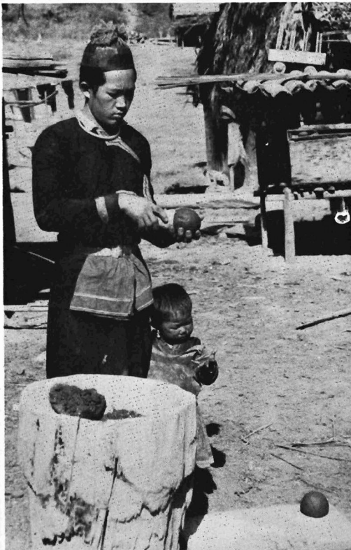
Abb. 2. Herstellung von Schmelztiegeln
