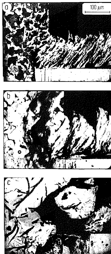
Abb. 2. Spanarten. a: Fließspan; b: Scherspan; c: Reißspan
