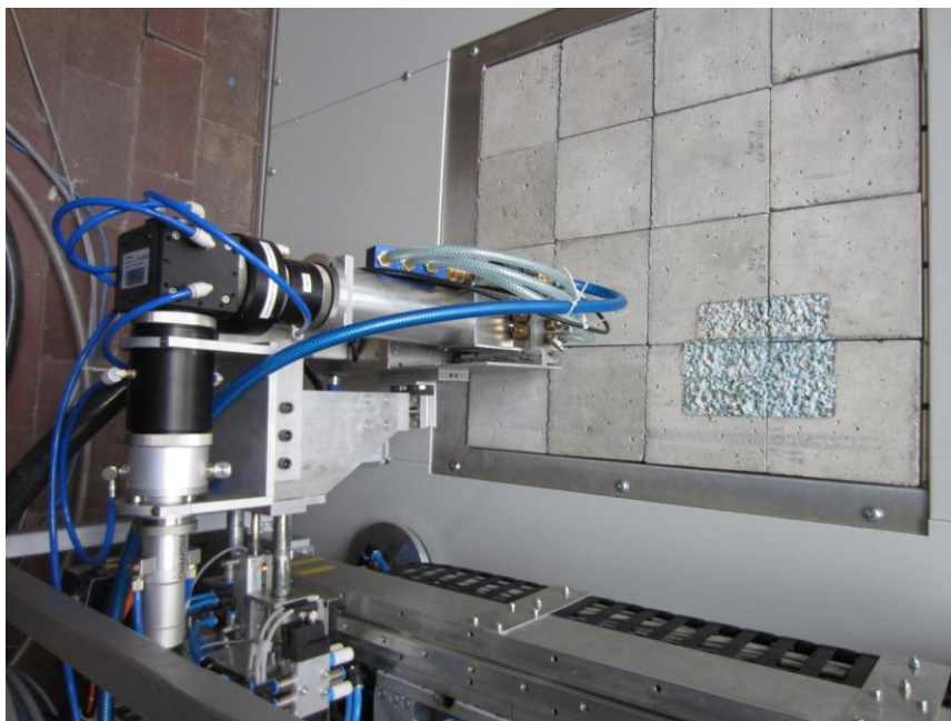
Abbildung 36: Blick von oben auf Arbeitskopf in Endposition und die bearbeitete Oberfläche
