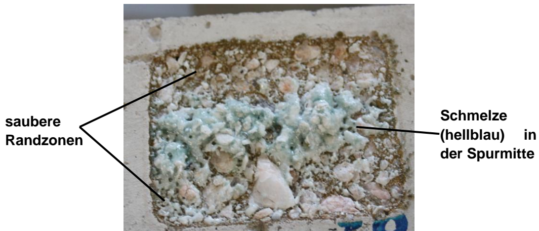
Abbildung 10: Spur aus Versuchsreihe S04-03 mit Schmelzeansammlung in der Mitte
