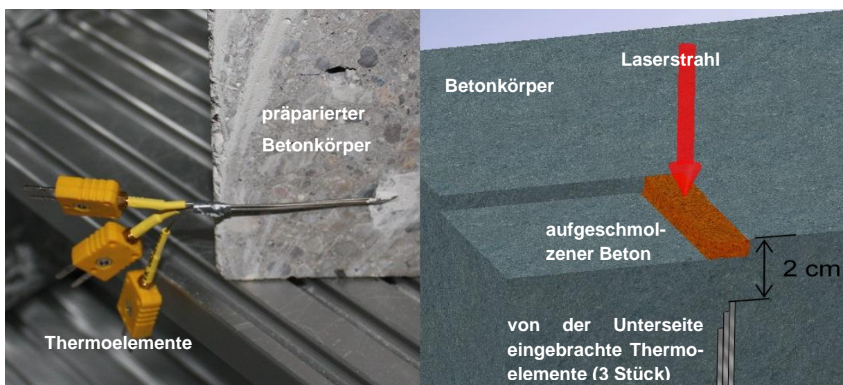
Abbildung 17: links: präparierter Stein mit Thermoelementen, rechts: Schema Querschnitt
