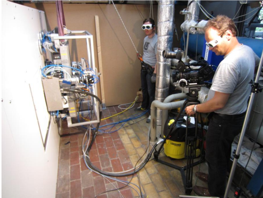
Abbildung 32: Videoaufnahme während der Versuche mit an der Versuchswand angesaugtem Manipulator
