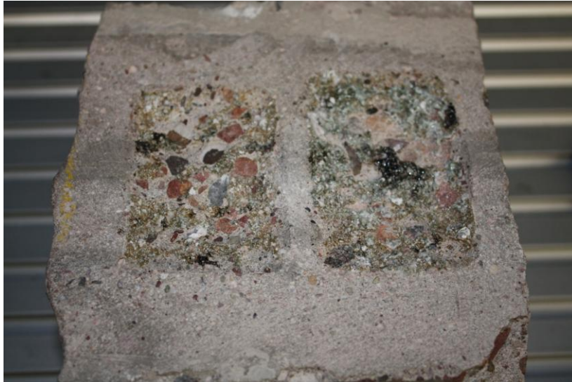
Abbildung 15: Laser bearbeitete Betonprobe aus dem KKW Würgassen
