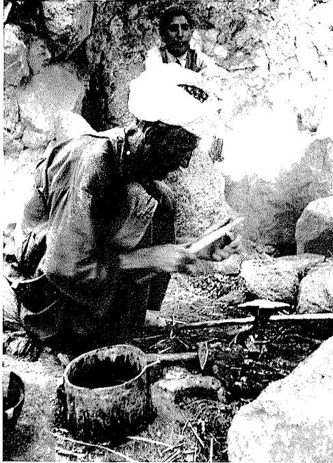
Abb. 11. Feilen des Hufeisens
