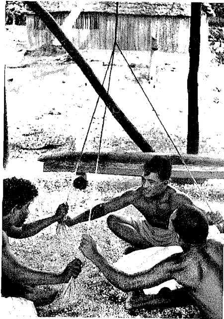
Abb. 3. Männer von Nououti beim Drehen eines Kokosfaserseiles (ro)
