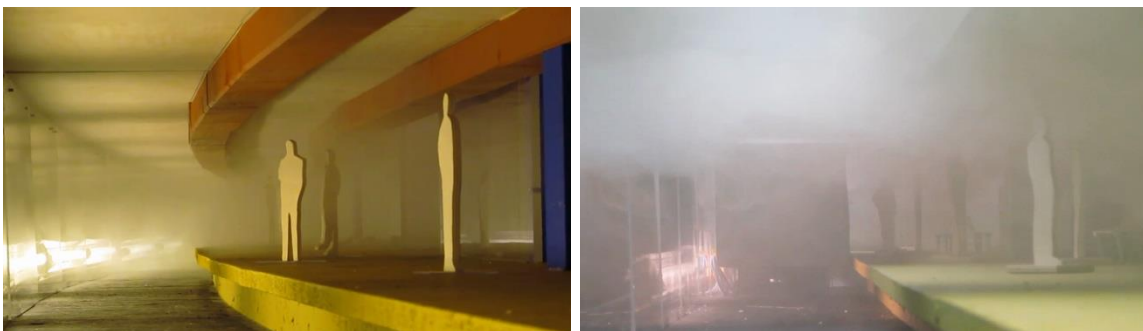
Bild 3.20: U9-Ebene deutlich verraucht; rechts: U8-Ebene stark verraucht
