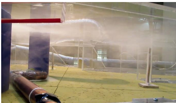
Rauchausbreitung in Brandabschnitt 2
