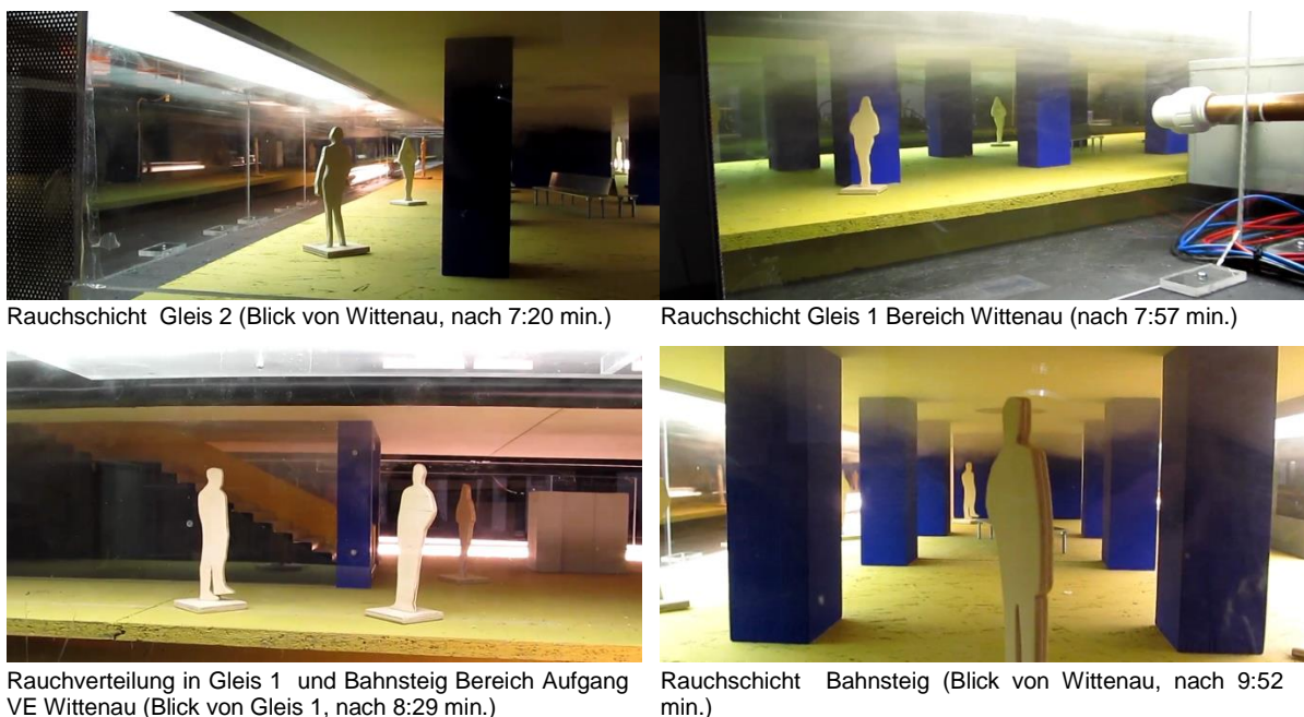
Bild 3.34: Rauchausbreitung bei beidseitiger Drallentrauchung in der U8-Ebene mit 2 \times 184.000 \text{ m}^3/\text{h}
