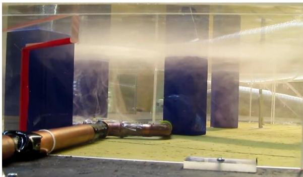
Rauchausbreitung im Bereich des Brandherdes, keine Rauchübertritt an der Fluchtöffnung
