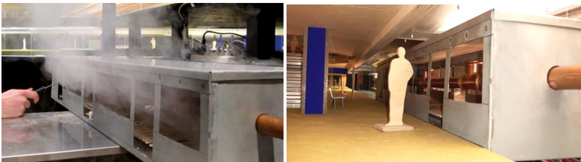
Bild 3.15: Brandherdmodell U-Bahn F84 im Maßstab M 1:15 (links: Test außerhalb des Modells; rechts: Waggon im Modell)
