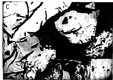
Abb. 2. Spanarten. a: Fließspan; b: Scherspan; c: Reißspan
