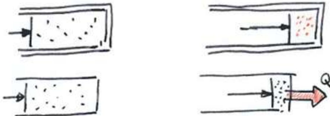
Abbildung 59: isotherme und adiabatische Kompression eines Gases
