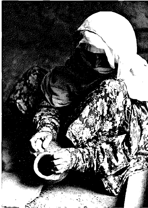
Abb. 14. Anpolieren mit einem Kiesel
