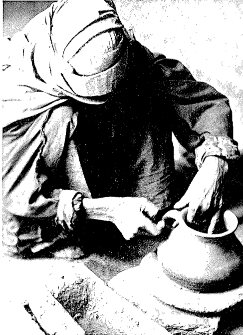
Abb. 13. Ansetzen eines Henkels
