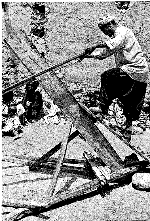
Abb. 4. ALI MOH OU BOUZ und das in der Haltevorrichtung verspreizte Arbeitsstück
