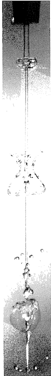
Abb. 4. Blitzlichtaufnahme eines stark gestörten Wasserstrahles (Düsenradius R_d = 1,6 mm, Grundgeschwindigkeit U = 4,29 m/s, Störfrequenz f = 60 Hz, relative Störampplitude \varepsilon > 0,5 )
