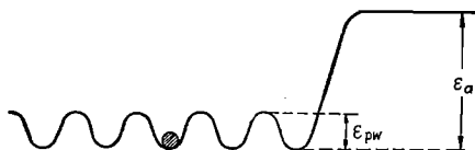
Abb. 1. Schematische Darstellung der Platzwechselenergie \varepsilon_{pw} und der Adsorptionsenergie \varepsilon_a
