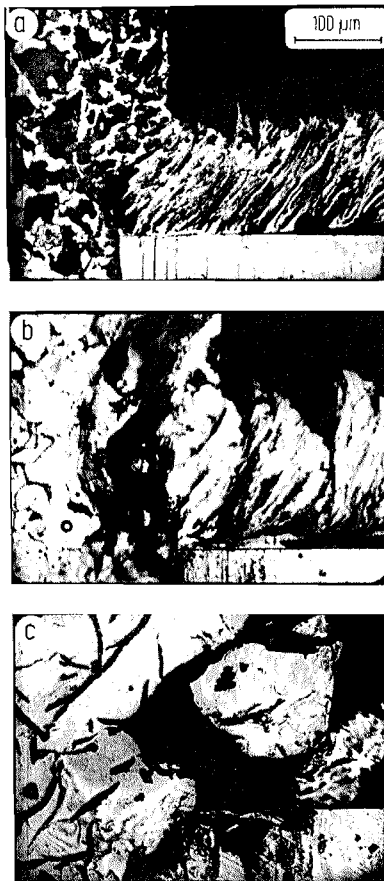
Abb. 2. Spanarten. a: Fließspan; b: Scherspan; c: Reißspan
