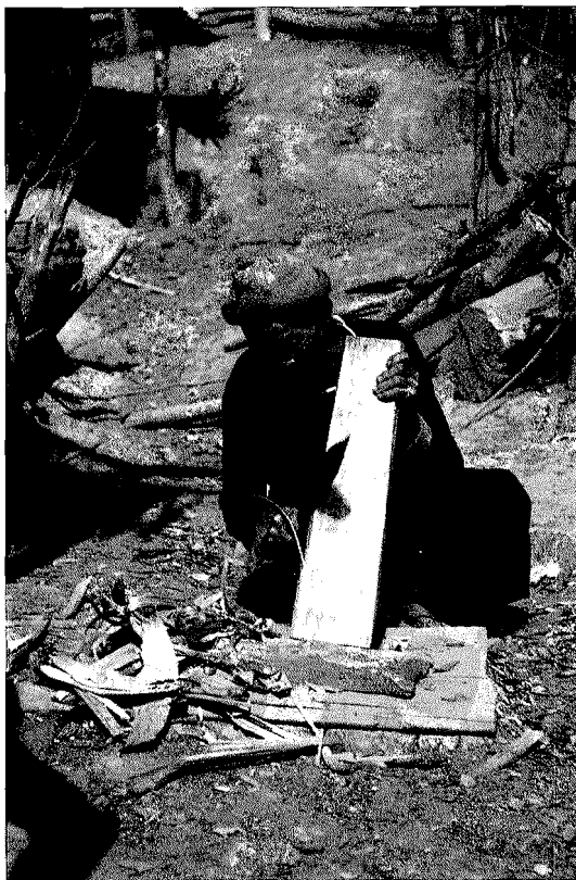
Abb. 2. Einschrägen einer Daube
