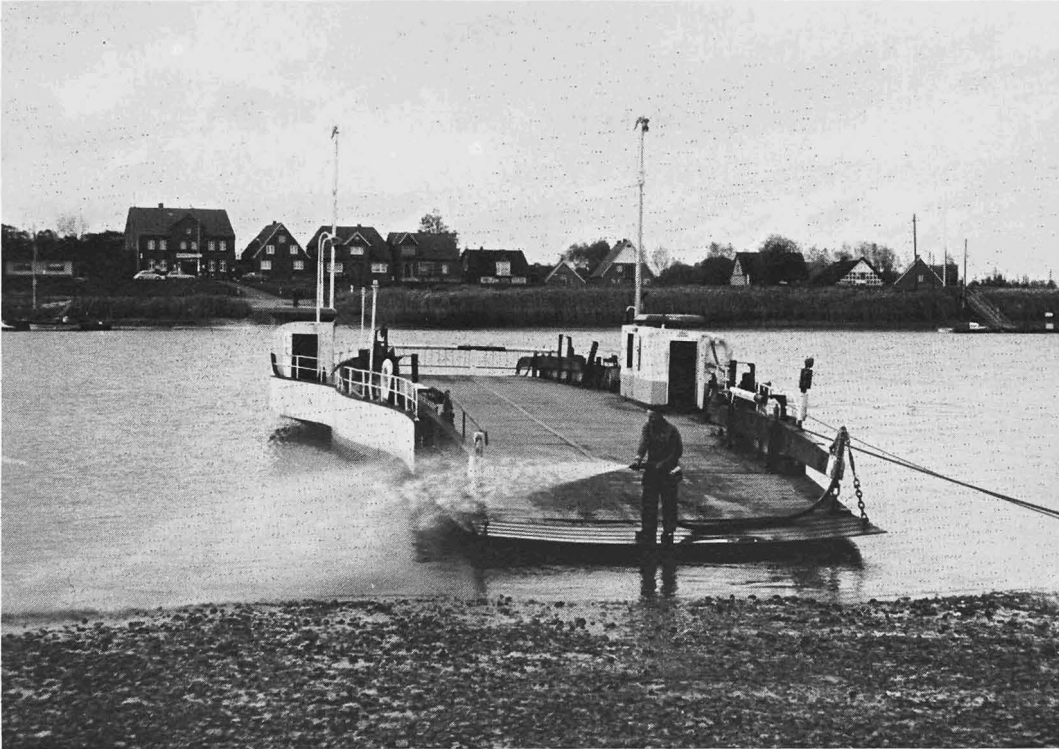
Abb. 3. Motorseilfähre Geversdorf. Blick in Richtung Ostufer. Mit einer motorgetriebenen Waspumpe wird bei fallendem Wasserstand der Schlick weggespült. Dieses „Speckenspülen“ ermöglicht einen gefahrlosen Zugang. Rechts das dicke Führungsseil mit dünnem Zugseil, das über eine Spillwinde läuft. Diese Winde wird durch einen Dieselmotor angetrieben, der Prahm läuft über Laufrollen am Führungsseil entlang
